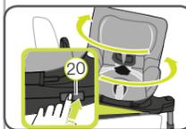
Lai nomainītu braukšanas virzienu, nospiediet pagriešanas pogu (20) un grieziet sēdekli vajadzīgajā virzienā, kamēr tas nofiksējas. Izņemot sēdekli pavērstu uz priekšu, aizsargrāmī (10) jāatrodas vertikālā pozīcijā.
