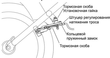
Для натяжения троса ослабить кольцевой пружинный замок и повернуть штуцер регулирования натяжения троса против часовой стрелки. Закрепить штуцер регулирования натяжения троса в новом положении, затянув кольцевой пружинный замок к скобе или рычагу тормоза.
